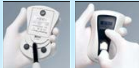
Eine Schablone auf der Rückseite des Gehäuses dient der Bestimmung des Durchmessers kreisrunder Lichtleiter.
